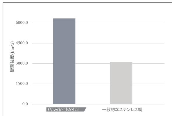
金属材料の衝撃強さを測定するための標準的な試験で広く利用されている“シャルピー試験”によって得られたデータです。
