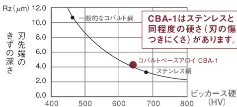
ステンレス鋼とコバルトベースアロイCBA-1を比較した場合、ステンレス鋼の方が硬度は高いです。しかし、刃先の鋭さの変化(試験機による実験)にあるように耐摩耗性はステンレス鋼より遥かに高くなっています。
