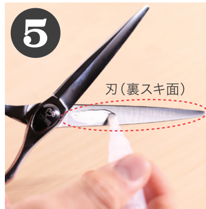
5 そのまま保管する場合は刃(裏スキ面)にもオイルを塗ります
